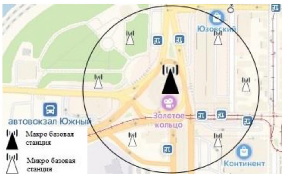
Рисунок 3.1 – Карта части г. Донецка с предполагаемым местом развертывания гетерогенной сети
