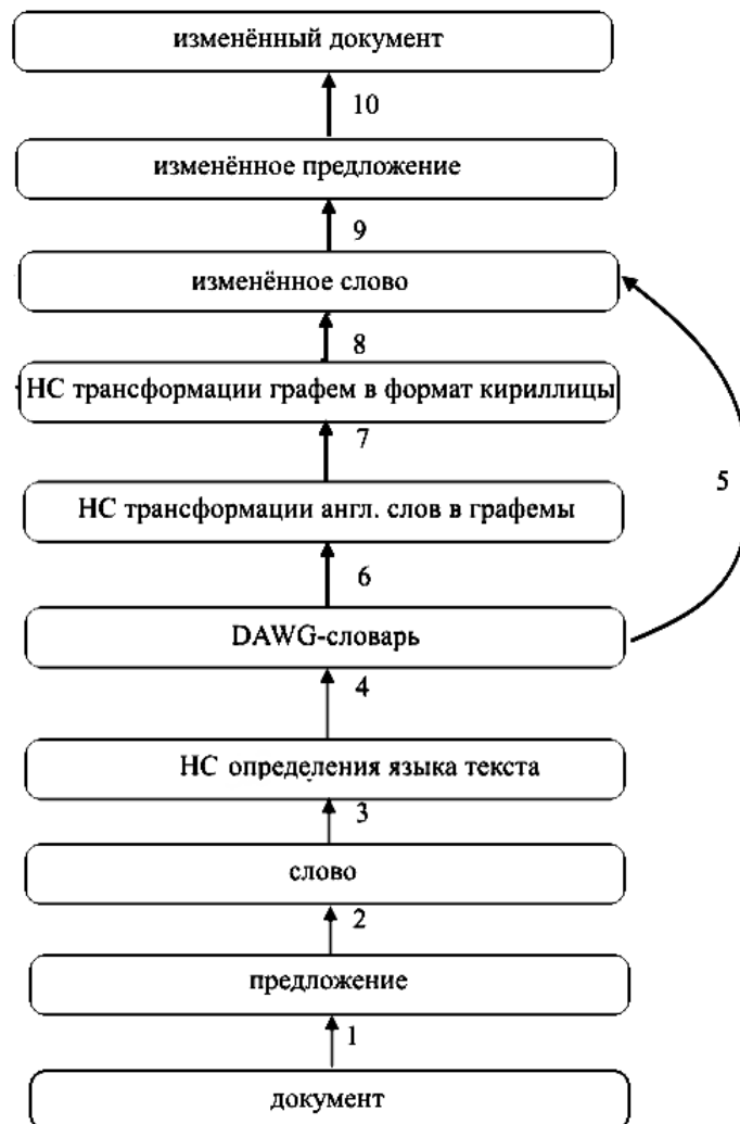
Рисунок 3.7 – Общая схема метода трансформации английских вставок
