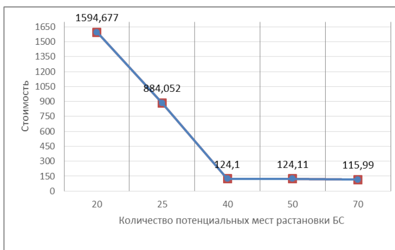
Рисунок 3 – Зависимость стоимости проектируемой сети от количества потенциальных мест расстановки базовых станций
