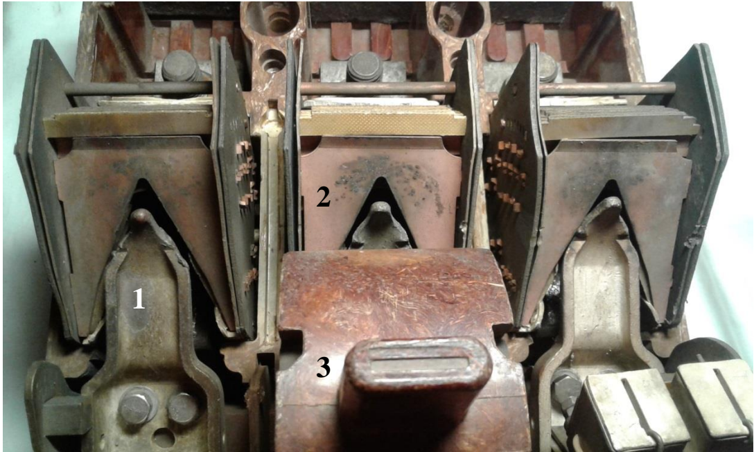
Рисунок 1.9 – Общий вид силовой трёхполюсной контактной группы автоматического выключателя А3792: 1 – подвижный контакт, 2 – дугогасительная камера, 3 – рукоятка выключателя
