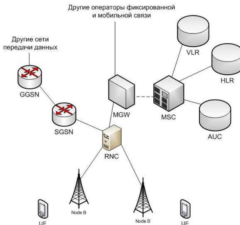
Рисунок 1.2 – Структура сети UMTS
