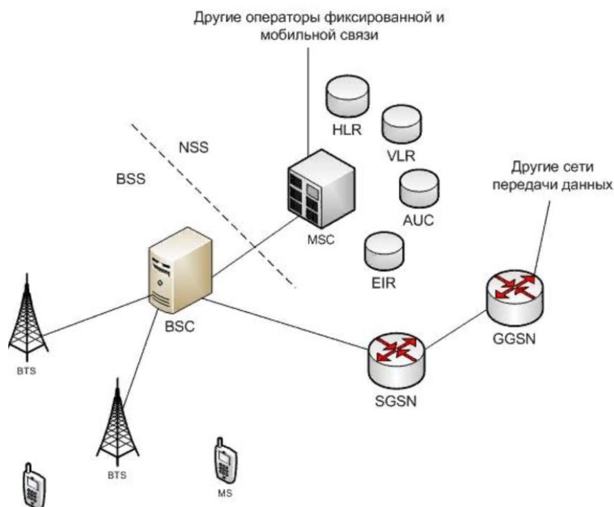
Рисунок 1.1 – Структура сети GSM
