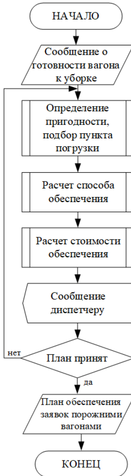
Рисунок 4.4 – Общий алгоритм управления процессами обеспечения порожними вагонами перевозок специфических грузов при введении АСУ ОПВ
