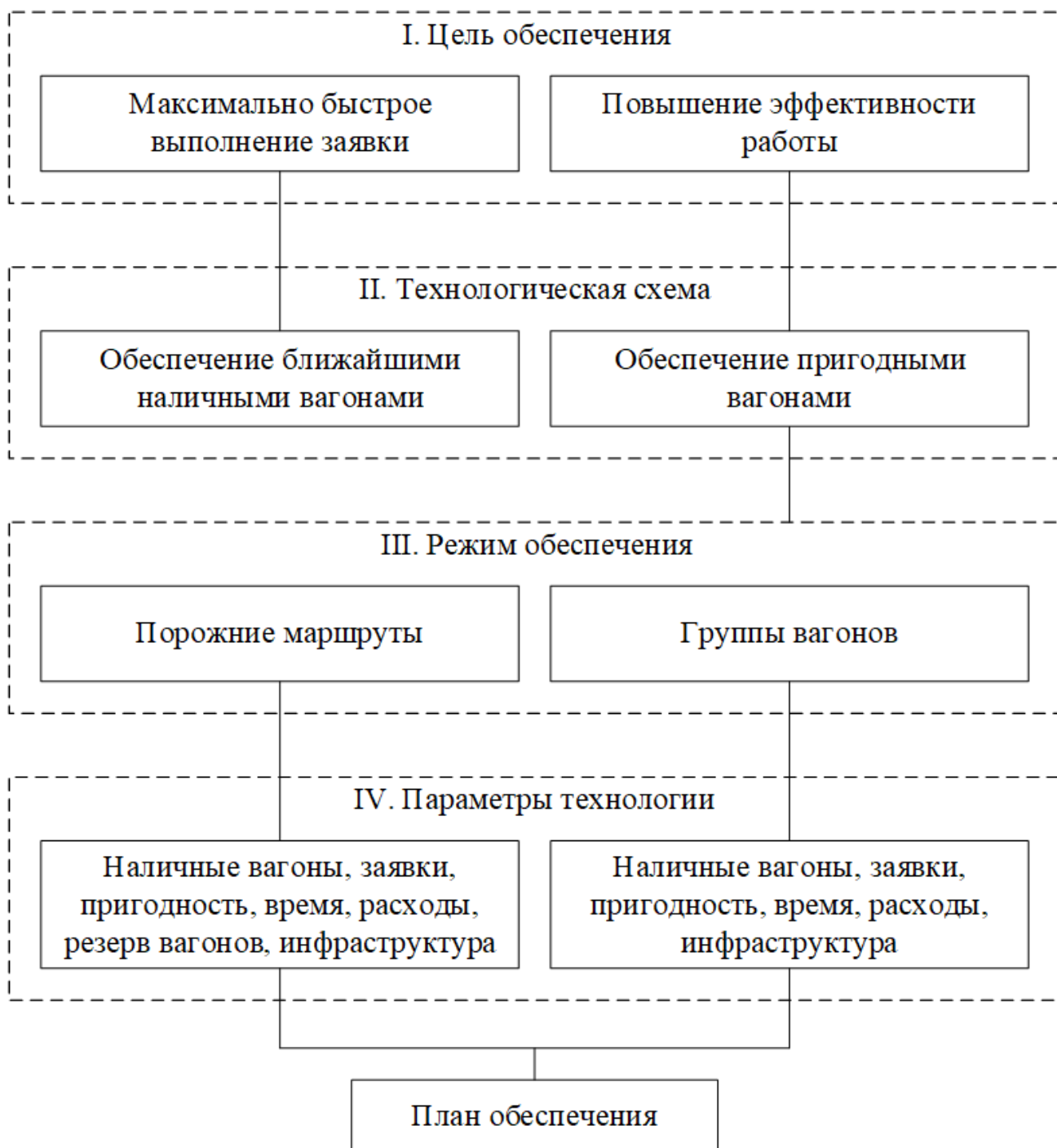
Рисунок 4.1 – Функционально-логическая схема планирования управления процессами обеспечения порожними вагонами перевозок специфических грузов
