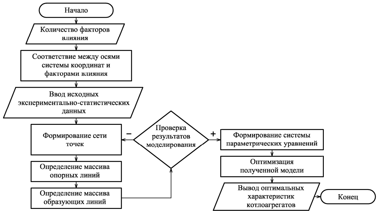
Рисунок 4.5 – Блок-схема вычислительного алгоритма моделирования и оптимизации конструктивных и эксплуатационных характеристик жаротрубных КА
