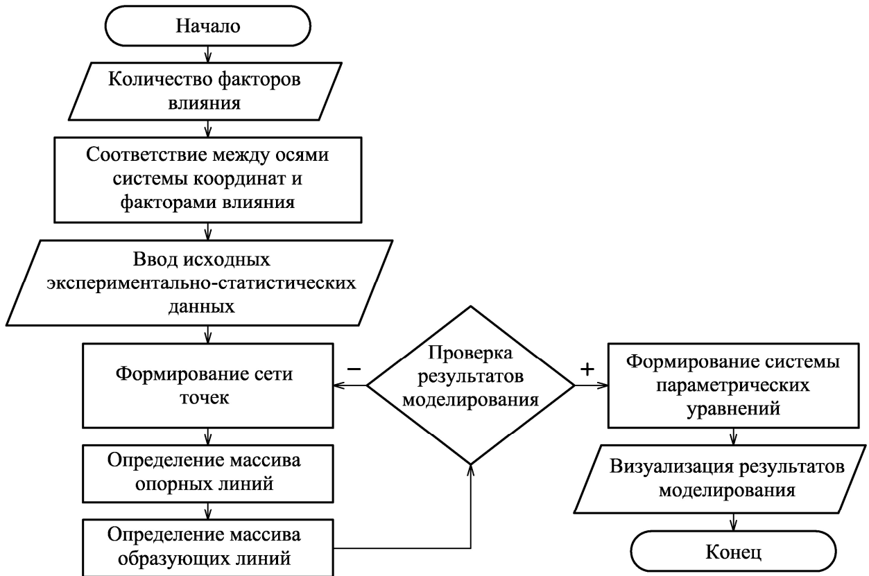
Рисунок 2.5 – Блок-схема вычислительного алгоритма геометрического моделирования многофакторных теплообменных процессов
